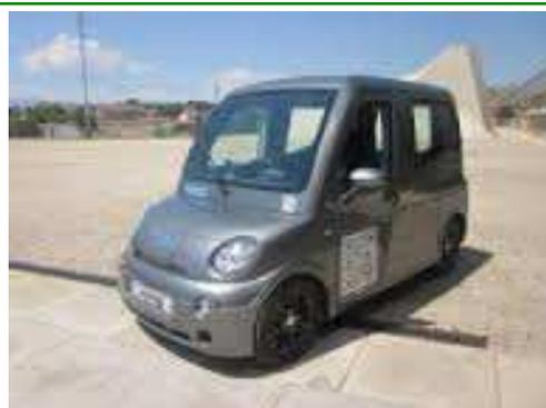
**Kimsi, le monospace adapté** : Franck Thomas a conçu Kimsi, un petit monospace électrique, réservé à la mobilité des personnes handicapées utilisable sans permis. C'est une voiture bâtie autour du fauteuil roulant. La montée se fait à l'arrière grâce au plancher qui s'abaisse jusqu'au sol. Le véhicule a 150 kms d'autonomie et un second passager (valide ou appareillé) peut y prendre place. La fabrication se fera en Vendée par l'entreprise Bellier.
